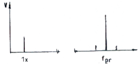
Figura 3.3: Picos típicos en el espectro de vibración de un motor trifásico
